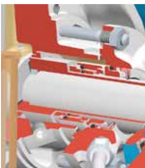
MQ3 HJ92N / HJ977GN Pojedyncze uszczelnienie mechaniczne, odciążone, zabezpieczenie przed suchobiegiem, zbiornik cieczy buforowej, tuleja na wale
