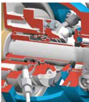
MW2 MG12 / M7N Pojedyncze uszczelnienie mechaniczne, nieodciążone, z płaszczem grzewczym, chłodzącym, tuleją wału
