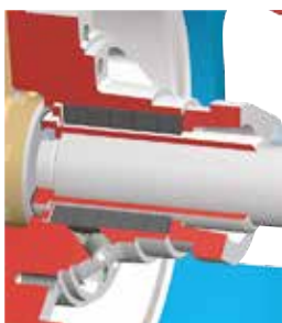
S2 uszczelnienie pakułowe na tulei wału
