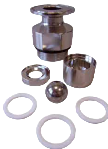
Przyłącza Clamp i zawory kulowe w wykonaniu ze stali SS316L o chropowatości Ra<0,8 \mu\text{m} , uszczelki z PTFE (aprobata FDA)
