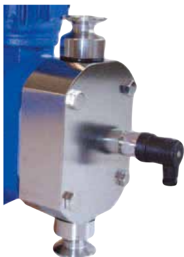
Elektropolerowana głowica pompy Ra<0,8 \mu\text{m} z wyłącznikiem ciśnienia do monitorowania pękniętej membrany
